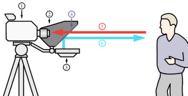
Esquema del teleprompter: (1) Cámara de vídeo. (2) Tela. (3) Monitor. (4) Cristal reflectivo. (5) Imagen del sujeto. (6) Imagen del monitor.
